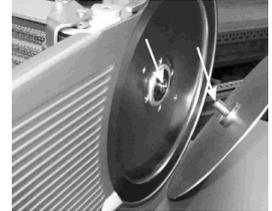
Fetten Sie das Gewinde des Sternknopfes am Schlittentisch (werkseitig wird hier Autol Top 2000 verwendet).
