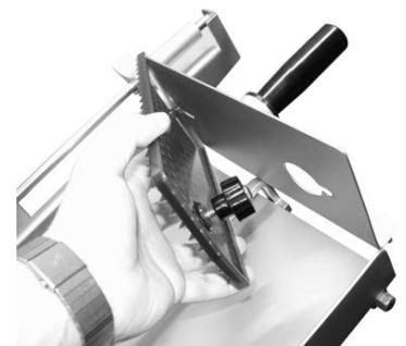
Gemäß der Unfall-Verhütungs-Vorschrift VGB 19 § 20 Abs. 2 vom 1.4.90, darf das Messer nur noch bis zu einem gewissen Maß abgeschliffen werden. Wenn der Spalt zwischen Messerschneide und Messerschutzing max. 5 mm beträgt, muss das Messer ausgetauscht werden.
